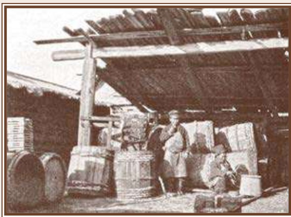
Рис. 13.4. Бондарное отделение одного из нижнеангарских рыбоделов в Дагарах. Бочки на 25 пудов начала 20 века, один из бондарей делает лагуны (по: Кузнецов, 1909)
